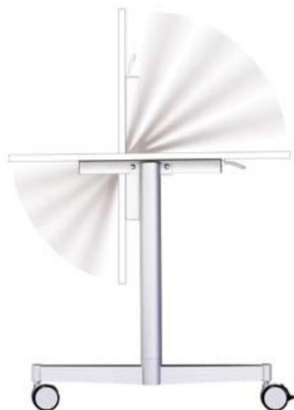
Klappmechanismus für leichtes und sicheres Schwenken der Tischplatte
